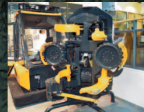
De header van Ponsse rooit, zaagt, stript en meet stammen tot maximaal 74 centimeter.
