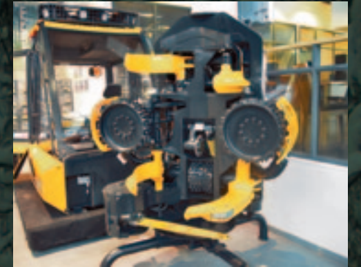
De header van Ponsse rooit, zaagt, stript en meet stammen tot maximaal 74 centimeter.
