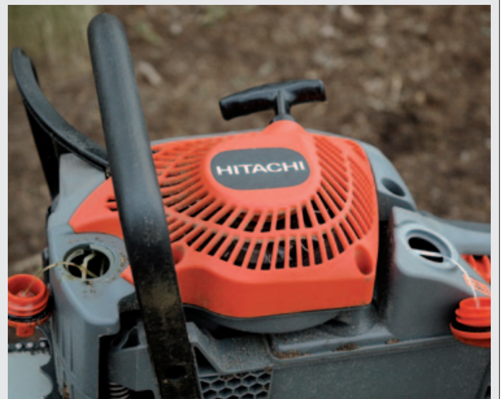
De zaag ligt stabiel op z'n linkerzijkant, waarna het vullen met kettingolie (links) en benzine (rechts) weinig om het lijf heeft. Het startkoord vraagt een krachtige hand.
