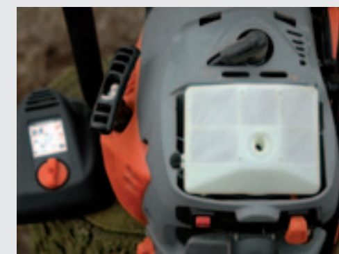
Het luchtfilter is makkelijk bereikbaar na het losdraaien van het kapje.
