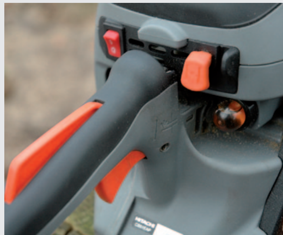
Met de klok mee, linksboven: de aan-/uit schakelaar, de choke, het pompje voor de benzine, het handgas en (bovenop de greep) de veiligheidspal.
