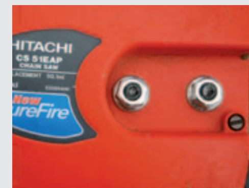
Het rechter schroefje spant de ketting nadat de moeren daarnaast iets zijn losgedraaid.
