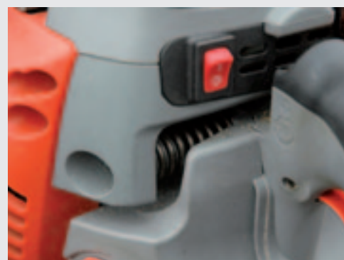
De motor hangt in spiraalveren en brengt nauwelijks trilling over op de handgrepen.
