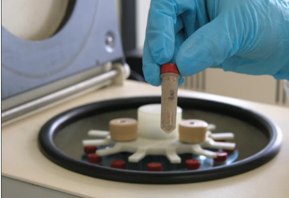
De rattenkeutel wordt fijn gemalen in een vloeistof met een krachtige schudder
