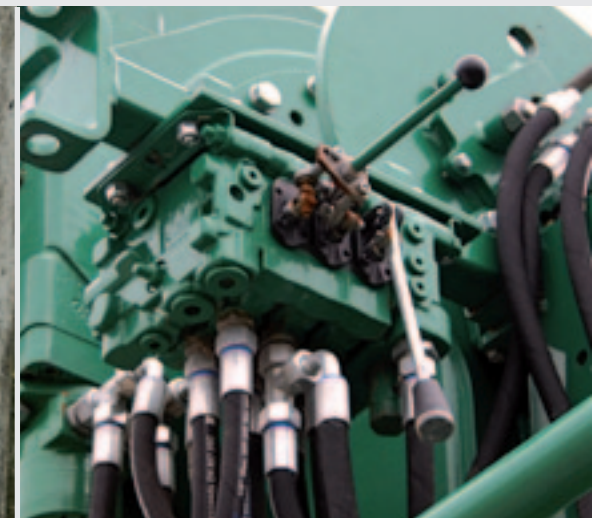
De besturing is eenvoudig. Met twee hendels zijn alle handelingen uit te voeren.
