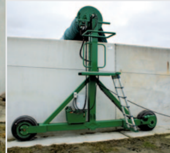
Eén kant van het portaalsysteem die vanaf het platform wordt bestuurd.
