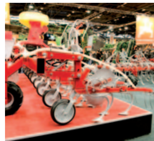
De schoffelmachine maakt in Scandinavische landen een comeback, nu de overheden aldaar extra belasting op chemische middelen heffen. De Kongskilde Vibro Crop is voorzien van een sideshift en een camera die ervoor zorgt dat je dicht langs de rijen van het cultuurgewas kunt schoffelen. Met de machine is een rijnsnelheid mogelijk van 12 tot 15 km/h. Om ook op gerende percelen zoveel mogelijk te kunnen schoffelen, is met behulp van gps-technologie elk element afzonderlijk automatisch te heffen.
