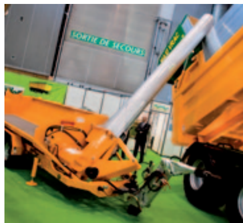
De Franse fabrikant Remorques Gourdon heeft een graanstortbak ontwikkeld, waarmee je graan vanuit de kiepwagen in een vrachtwagen draait. Een vijzel onderin de stortbak stuwt het graan naar de voorkant van de stortbak. Een losvijzel draait het graan vervolgens op de vrachtwagen. De stortbak heeft een capaciteit van 300 ton per uur en voor de aandrijving is een trekker van 59 kW (80 pk) nodig. Voor transport wordt de losvijzel overeind gezet en dan hydraulisch over de stortbak gelegd.
