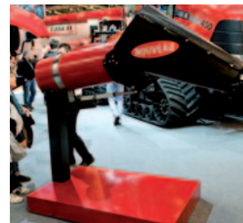
Een aardigheidje op de stand van CaselH. Of is het meer dan dat? De fabrikant heeft de tuit aan de losvijzel hydraulisch bedienbaar gemaakt. Daardoor is het vanuit de maaidorser eenvoudiger om in het midden van de (vracht) wagen te lossen, ook als je wat te ver van de wagen staat. Ook kun je relatief eenvoudig de hoeken van de wagen vullen. Maar er is meer. In de hoogste stand sluit de tuit ook de afvoervijzel in zijn geheel af. Morsen behoort daarmee definitief tot het verleden.
