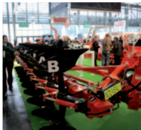
In navolging van het Nederlandse Rumpstad heeft de Franse fabrikant Bugnot een ecoploeg ontwikkeld, waarmee je tot 15 cm diepte kunt ploegen. Vooral biologische boeren, die organische stof bovenin de bouwvoer willen houden, tonen interesse. De breedte per ploegschaar is 29 cm en de trekker rijdt bovenover. Om de ploeglichamen te beschermen, is de halfgedragen wentelploeg per element uitgerust met een obstakelbeveiliging met accumulator. De ploeg is leverbaar met zeven tot tien scharen.
