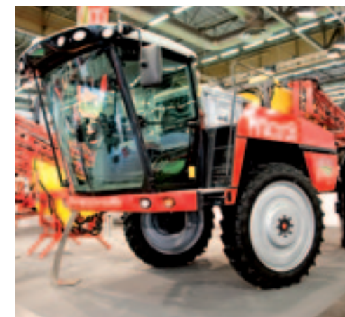
De Belgische spuitenfabrikant Beyne liet op de Sima een nieuwe zelfrijder zien. De machine heeft een cabine van Claas en een commonrail-kraftbron van Perkins met 179 kW (238 pk). De Anaconda is verkrijgbaar met een tank van 4.000 of 5.000 liter. De spuitboom is 24 tot 42 meter breed. Gps met sectieaansturing is standaard, net als twee pompen die beide 265 liter water per minuut verpompen. Met vijf sensoren bepaalt de Anaconda met de Distance-Control zelf de boomhoogte.
