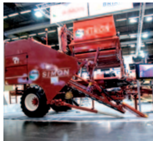
De Franse fabrikant Simon heeft het dagelijks onderhoud en het schoonmaken van de getrokken wortelrooiers eenvoudiger gemaakt. Zo hebben veel framebalken van de eenrijige R1B32 een ronde of ovale vorm gekregen waardoor grond makkelijk van de machine valt. Verder heeft de fabrikant de steun van de schaar onder de trekriemen voorzien van een breekbout. Stuit je op een obstakel dan breekt die en schuift de schaar in. Een nieuwe breekbout erin en je kunt weer verder.
