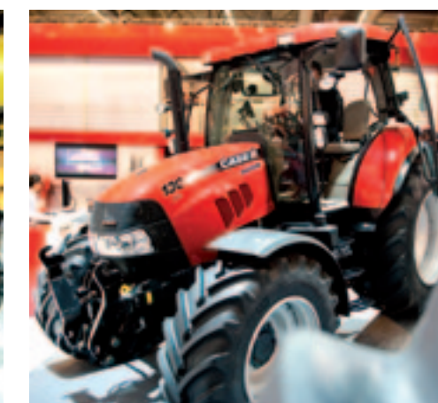
▲ Als New Holland met een viercilinder trekker met cvt komt, kan concerngenoot Case IH niet achterblijven. De trekker gaat als Maxxum CVX door het leven. Net als bij New Holland zijn er drie trekkers met cvt. De trekkers hebben een 4,5 liter FPT-motor. Je bedient de trekker met de multihendel en de dubbele gashendel. In tegenstelling tot de New Holland-versies, die uit het Engelse Basildon komen, worden deze trekkers in het Oostenrijkse St. Valentin gebouwd.
