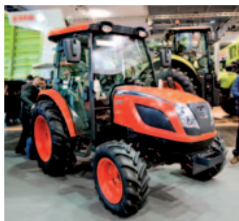
▲ Kioti, de Zuid-Koreaanse trekkerbouwer, voldoet met de nieuwe NX5510 aan de Stage 4 emissie-eisen. Het trekkertje heeft een Kioti viercilindermotor van 41 kW (55 pk). Kioti maakt gebruik van EGR, een klep die een deel van de uitlaatgassen weer in de motor brengt om daar te laten verbranden. Een roetfilter haalt resterende roetdeeltjes uit de uitlaatgassen. De NX5510 rijdt 30 km/h. Dat kan met een hydrostatische transmissie als een mechanische. Het hefvermogen ligt op 1.700 kg.
