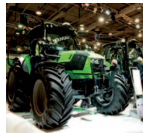
▲ Nog een trekker met een viercilindermotor en optionele traploze transmissie. De Deutz-Fahr 5-serie. De vier trekkers hebben een Deutz-motor met EGR en een katalysator. Het vermogen bedraagt 72,5 tot 93 kW (98,5 tot 127 pk). De drie kleinste modellen zijn ook leverbaar met een gangbare 10/10-, 20/20-, 30/30- of 60/60-transmissie. Het drie grootste modellen zijn er met de traploze transmissie. De trekker tilt maximaal 6.600 kg. De aftakas kent vier snelheden: 540, 540E, 1.000 en 1.000E.
