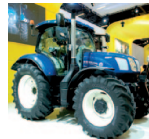
▲ En de laatste viercilinder met cvt dan maar: de New Holland T6 is er nu met de AutoCommand-traploze bak. Het gaat om drie trekkers uit de T6-serie met een vermogen van maximaal 105 tot 120 kW (143 tot 160 pk). Bij gereed toerental rijdt de trekker 40 km/h. De hef tilt volgens de fabrikant maximaal 7.864 kg. De trekkers hebben een verstelbare Sidewinder-armleuning, met de CommandGrip-joystick en een kleurentouchscreen met een beelddiagonaal van 26,4 cm.
