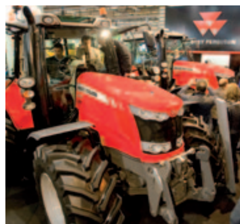
▲ Trekkerbouwer Massey Ferguson introduceerde tijdens de Sima de nieuwe 6600-serie. De vijf modellen zijn voorzien van 4,9 liter viercilinder AgcoPower-motoren met AdBlue van 90 tot en met 120 kW (120 tot en met 160 pk). Drie van de vijf trekkers zijn uit te rusten met een viertraps powershift, vier met een zestraps powershift en drie met een traploze transmissie. Doordat het maximale vermogen van het topmodel 185 pk bedraagt, is de 6616 dus voorlopig de sterkste viercilinder op de markt.
