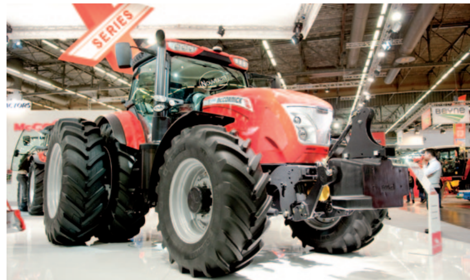
▲ De McCormick X7 volgt de X70-serie op en is er in zes modellen. Drie viercilinders met een vermogen van 107 tot 124 kW (143 tot 166 pk) en drie zescilinders van 105 tot 131 kW (141 tot 175 pk). De trekkers zijn voorzien van een Fiat Power Train-motor, een Carraro-vooras en een 24/24 ZF-versnellingsbak. In de zelfontwikkelde cabine vind je een armleuning met touchscreen en een multifunctionele hendel. Er is een knopje dat je zelf kunt programmeren en de trekker is voorzien van een kopakkermanagement. Ook opvallend: de bijrijdersstoel is in zijn opgeklapte staat volledig weggewerkt in het spatbord en zit dus niet in de weg.
