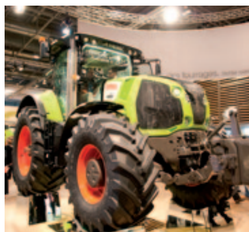
▲ Ook Claas heeft een trekker die de Stage 4 emissie-eisen haalt, al is de nieuwe Axion 800 pas volgend jaar leverbaar. De vier modellen uit de Axion 800-serie zijn uitgerust met 6,7 liter zescilinder FPT-motoren met een vermogen van 147 tot 198 kW (200 tot 270 pk). De trekker heeft nagenoeg dezelfde cabine als zijn grote broer, de Axion 900. De cabine telt vier cabine-stijlen en het zicht naar alle kanten is uitstekend, behalve op de trekhaak. Daarvoor zit de cabine net een beetje te ver naar voren.
