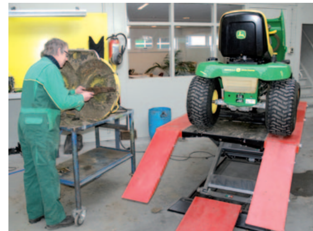
Het mes moet aan beide kanten even zwaar zijn, ofwel in balans zijn. Is dat niet het geval dan ontstaan trillingen en worden de lagers onnodig belast.
