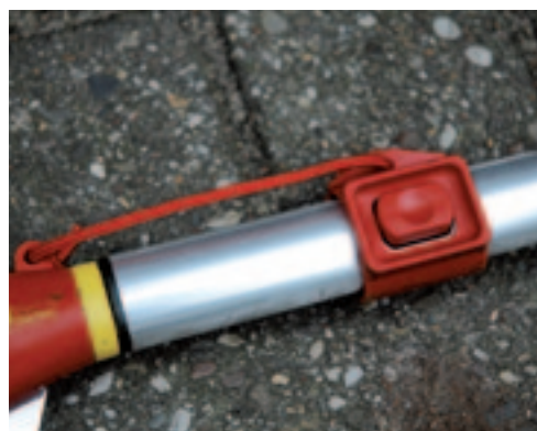
Het verwisselen van de zaag bij Wolf is snel te doen; de drukknop is voldoende beveiligd.
