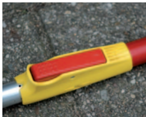
De lengteverstelling van de korte Wolf is probleemloos en heeft drie stappen van 43 cm.
