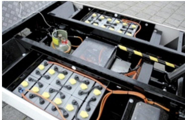
Een lood-zwavelbatterij kan 1500 keer worden geladen. Daarom is het aan te raden de batterij niet steeds bij te laden als die nog maar voor een klein deel is ontladen.
