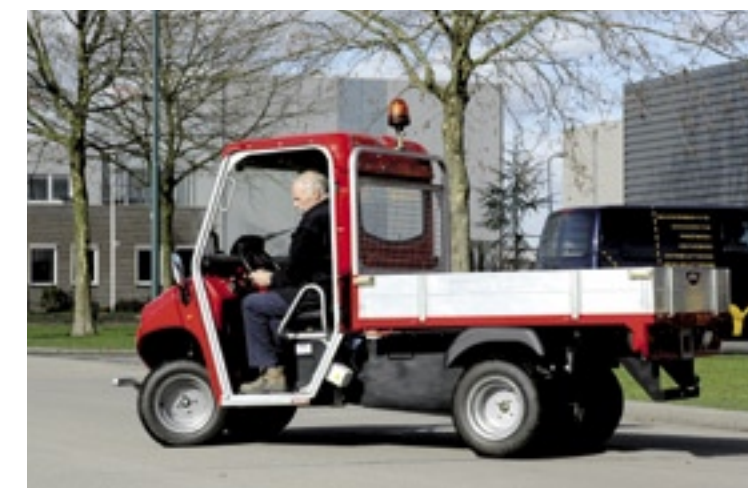
De elektrische Alké kan 520 kg laden. Hij lijkt op een Gator-achtige transporter, maar is wel volgens het concept van een typisch vrachtoetruig gebouwd.
