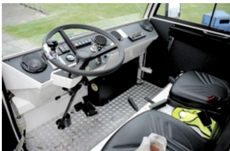
Kenmerk van een elektrische transporter is de eenvoud. Schakelen hoeft niet en zelfs remmen is maar zelden nodig omdat het voertuig sterk op de motor afremt.
