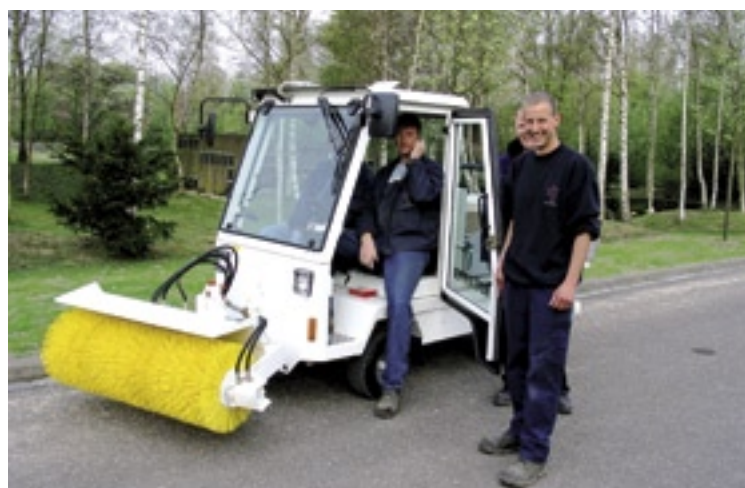
De Schmitz 1700 E elektrowagen kan zo'n 1.000 kg aan gewicht meedragen. Hij heeft onder meer een geveerde vooras en lage instap.
