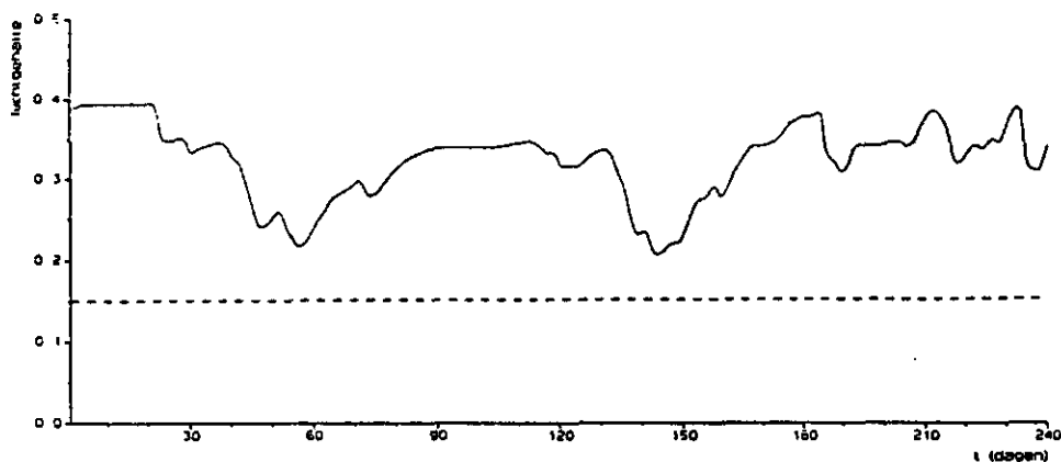
Figuur 4.10. Verloop van het luchtgehalte op 20 cm -mv. voor profiel 132 in het jaar 1972. Het profiel heeft de volgende opbouw : a. bovengrond : omgespoten zandgrond (2.0% slib) b. ondergrond : zavelachtig (grond Z1, bijlage B) c. draandiepte : 0.75 m -mv. d. maatgevende afvoer : 7 mm/dag
