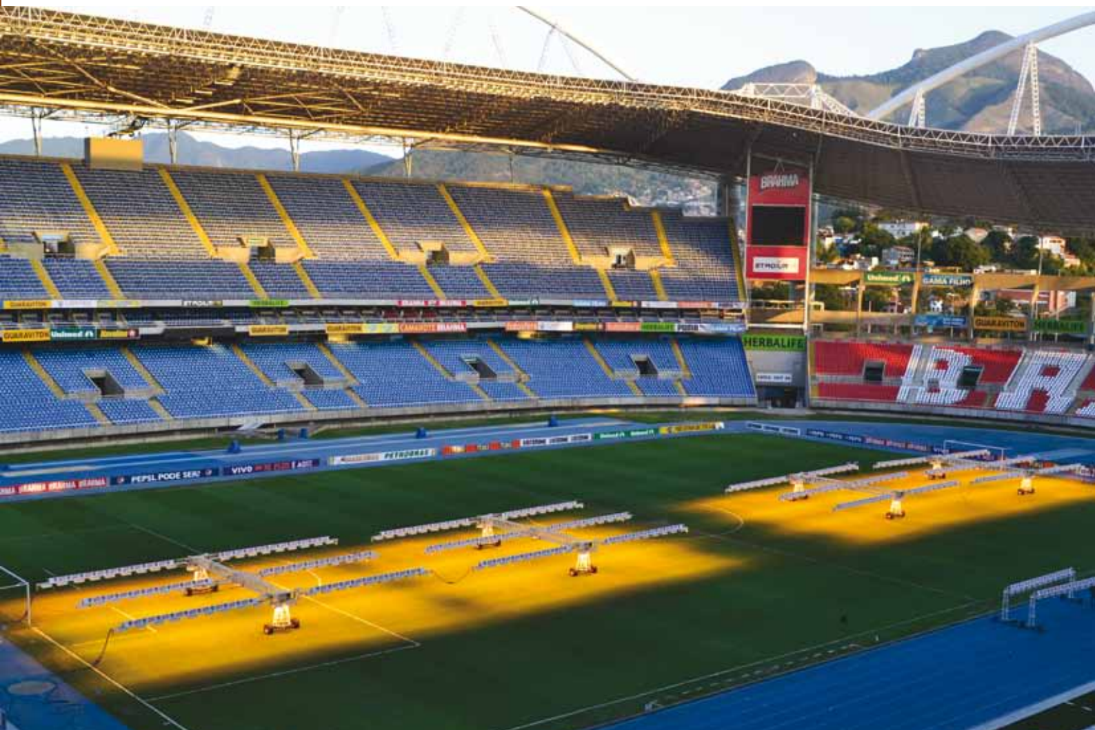
Stadions over ter wereld hebben hulp nodig om gras van voldoende licht te voorzien.
