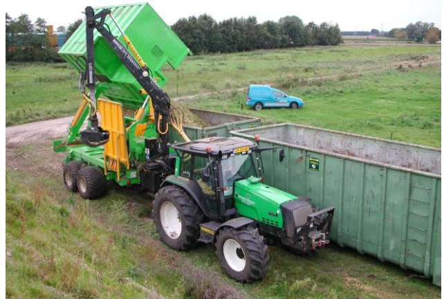
Figuur 2.3: ► Overslag van chips uit mobile opvangbak in containers (bron: Bruins & Kwast – Goor).
