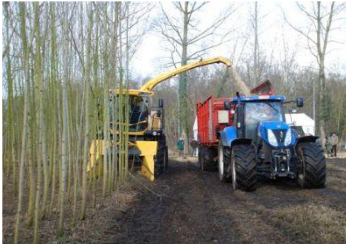
▲ Figuur b2.1: oogstmachine New Holland FR9000 Zeldegem België in actie: oogst van wilgen. De chips worden opgevangen in een landbouwcombinatie [New Holland].
