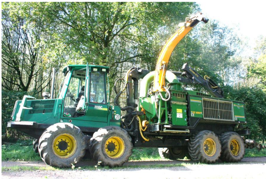
◀ Figuur 2.4: versnipperaar van 550 PK (Dutch dragon EC6060) met eigen invoerarm, op harvesteronderstel van Timberjack 1110C. Gegevens: invoeropening 60x60 cm; aandrijving John Deeremotor 550 PK; met een 4-messentrommel. Foto: maart 2012 Flevoland, (foto A. Kienhuis)
