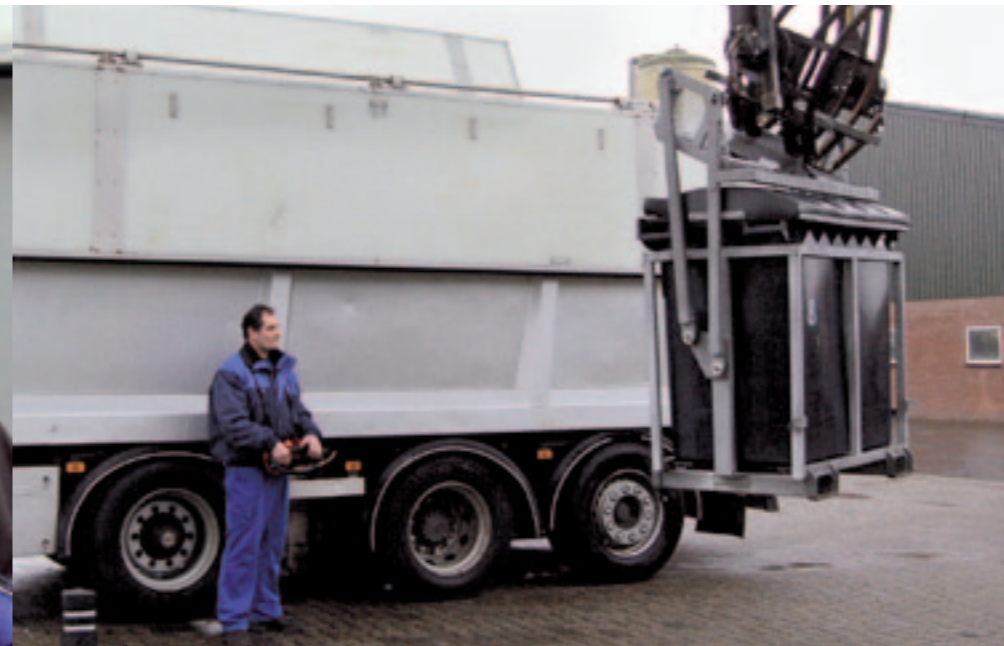
De kantelcontainer wordt discreet gelegd in de ophaalwagens. Varkenshouder Gerbert Oosterlaken (foto rechts) koos voor deze variant.
