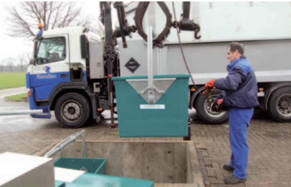
Op het bedrijf van varkenshouder Mark van Dijk (tweede foto van links) is een koelkelder gebouwd. Hierin staan twee stevige kadaverbakken. Links op de voorgrond het draaideksel die de container luchtdicht afsluit.
