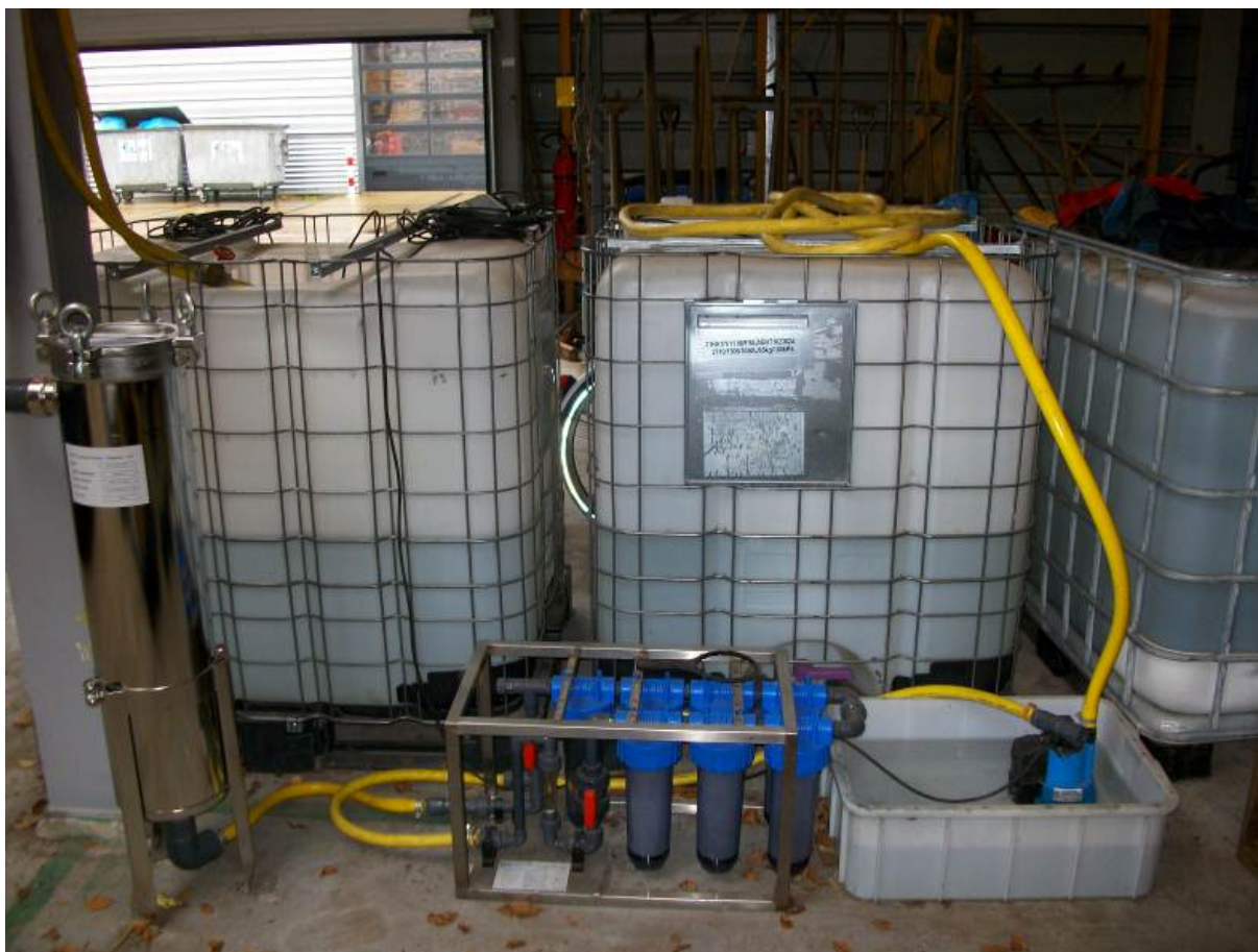
Figuur 6 Proefopstelling actief koolfilter PPO
