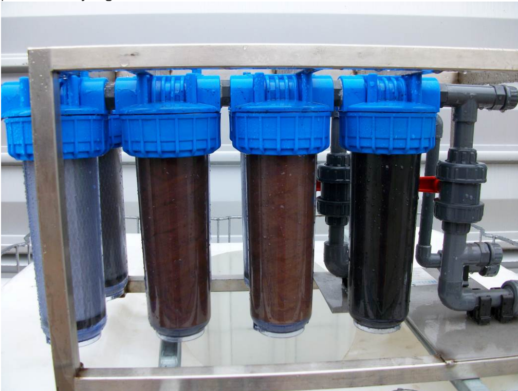
Figuur 3 Gebruikt actief koolfilter , bestaand uit 7 filterhuizen in serie. In de eerste drie filterhuizen zijn drie (bruine) kaarsen geplaatst voor opvang van zand- en stofdeeltjes gevolgd door 4 actief koolkaarsen.
