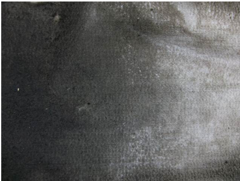
Figuur 9 Vervuiling van de filterzak van < 5 micron na filtratie van 3000 liter condenswater
