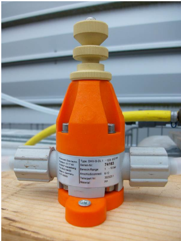
Figuur 12 Drukventiel voor het 'overwinnen' van tegendruk door vervuiling van de filterkaarsen.
