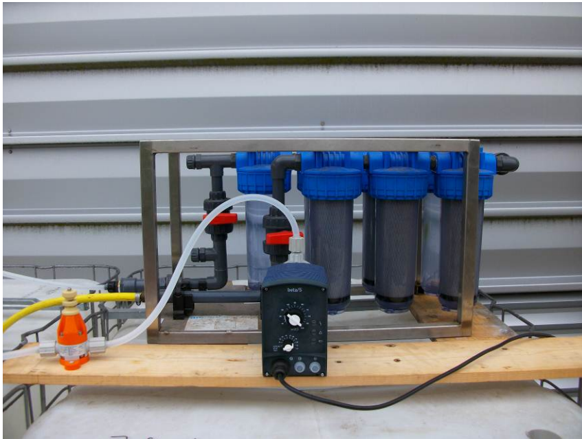
Figuur 13 Koppeling van een doseerpomp met drukventiel voor het verpompen van gezuiverd condenswater met een maximale druk van 3 bar door het actief koolfilter.
