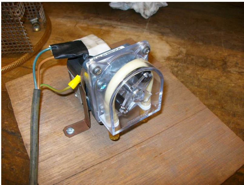
Figuur 10 Slangenpomp met een ingesteld debiet van 15 liter per uur.
