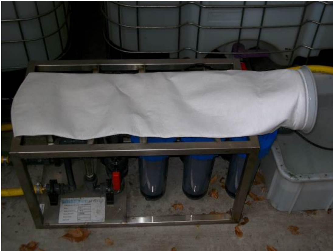
Figuur 8 Filterzak voor opvang van zand- en stofdeeltjes.
