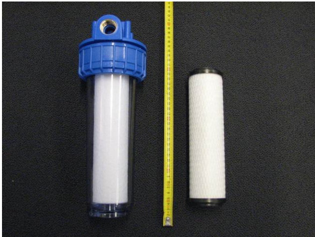
Figuur 4 Filterhuis (links) met actief koolkaars (rechts)
