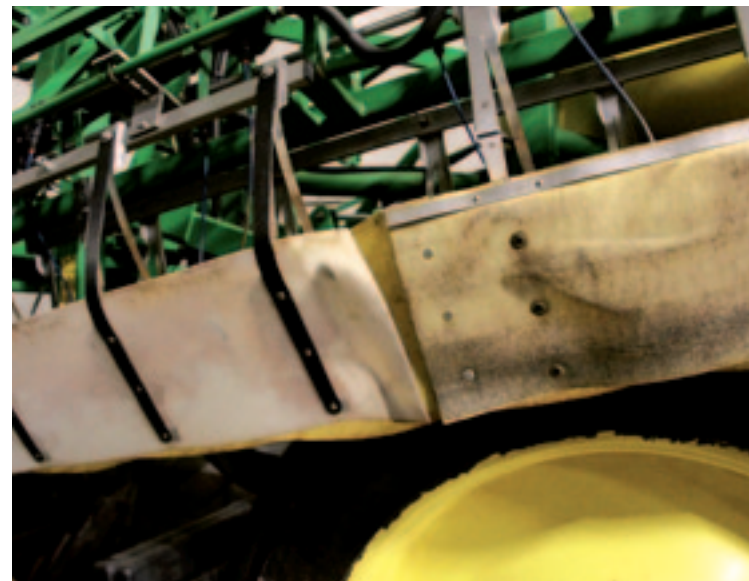
▲ Rechts de oude kunststof wing die door chemicaliën werd aangetast. Links de nieuwe wing die eenvoudiger is te reinigen.
