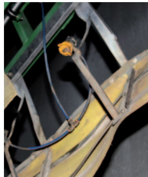
▲ De strips waren vroeger van verenstaal en tegenwoordig van thermoplastisch carbon.
