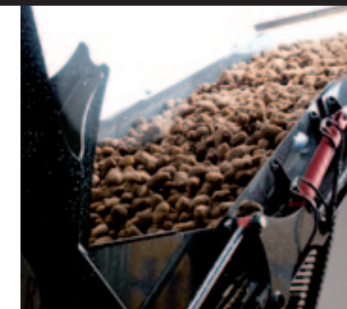
▲ Bij het lossen is het van belang dat de Pom-Over niet de steil staat afgesteld. Anders rollen de aardappelen terug.
