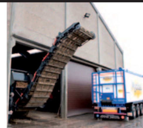
▲ De maximale loshoogte is 4,50 meter. Dat is ruim voldoende om rechtstreeks op een vrachtwagen te lossen.
