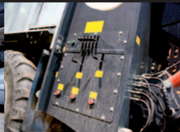
▲ De bestuurder bedient de hoogte en draaisnelheid van de Pom-Over aan de zijkant van de wagen.
