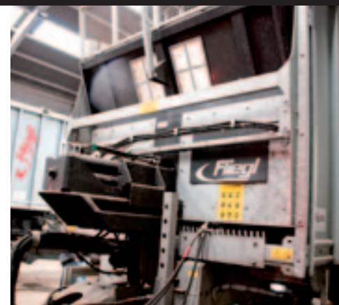
▲ Boven de dissel zijn twee cilinders geplaatst. Eén duwt de bodem naar achter, vervolgens duwt de ander de voorwand naar achteren.
