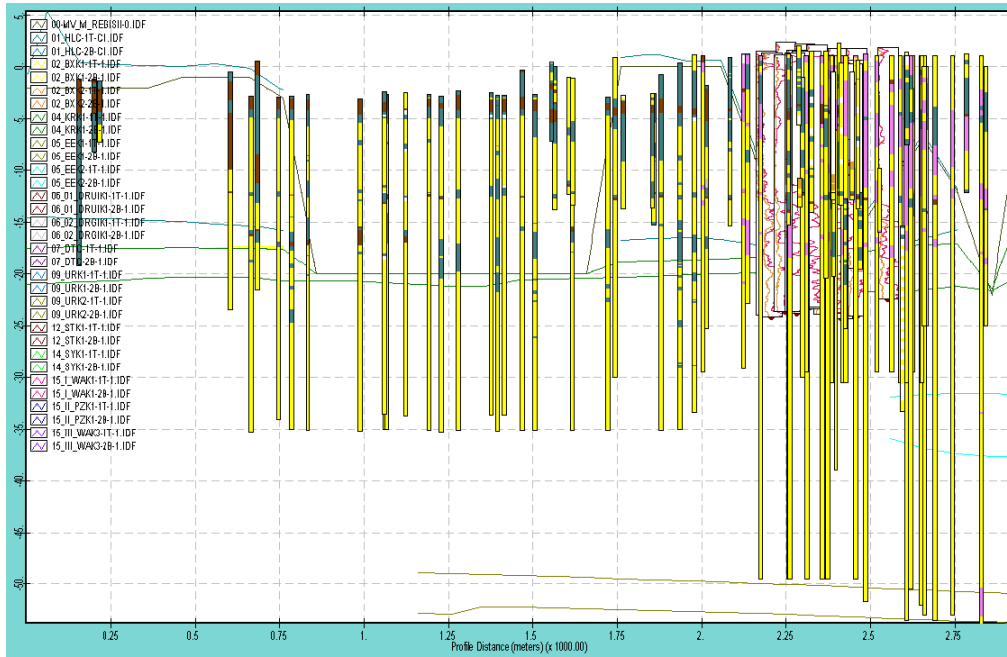
Figuur A-3. Sonderingen Noorder IJplaspolder dwarsprofiel noord-zuid. Geel = zand, bruin = veen, groen = klei, uit Imod (Deltares 2012).
