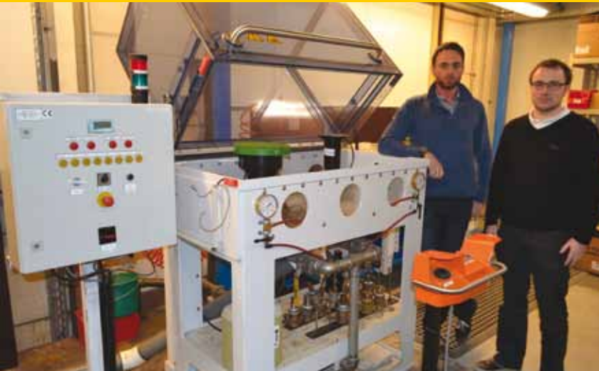
Het teststation waarmee de irrigatieafdeling sproeiers kan controleren.
