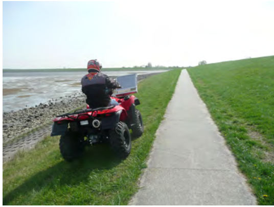
Figuur 1: Links; De microgolven scanner systeem is hier gemonteerd op een utility quad waardoor je op een snelle manier een dijk kunt inmeten. Rechts; De microgolven scanner is hier gemonteerd op een buggy waardoor je op een zeer gedetailleerde manier een dijk kan inmeten. De buggy configuratie is ook het meeste geschikt voor complexe gebieden (denk bijvoorbeeld aan een veenkade met veel hekken).
