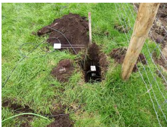
Foto 2.2 Herplaatsen van de sensoren
