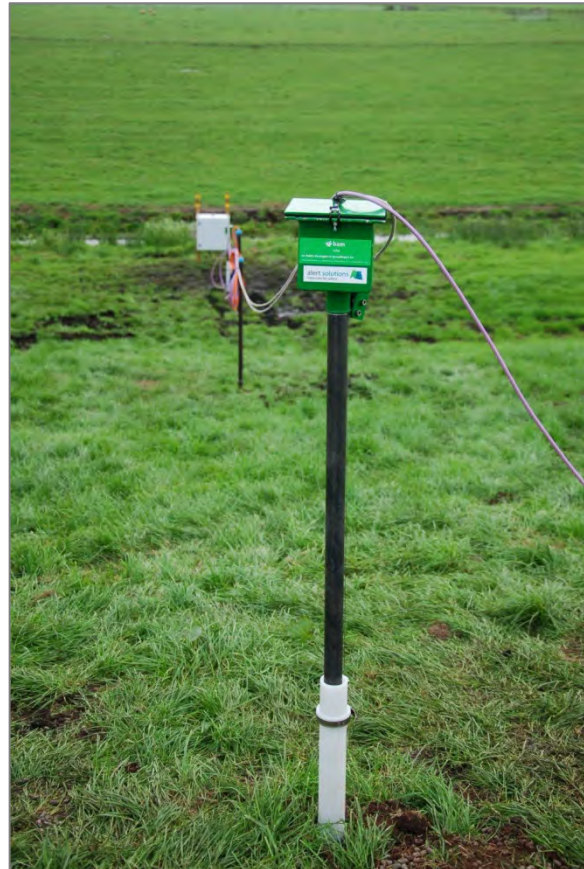
Figuur 3: foto's van de GeoBeads® sensoren in het talud (opgelengd met gasbuis) en de elektronische zakbaken
