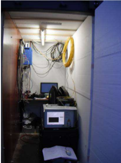
Figuur 5. De Brillouin interrogator geïnstalleerd in de container
