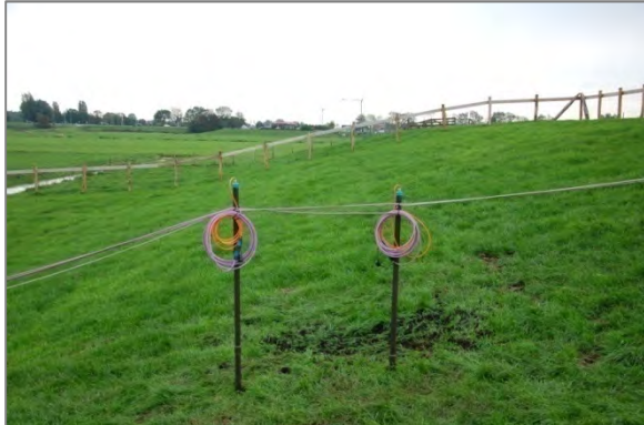
Figuur 3: foto's van de GeoBeads® sensoren in het talud (opgelengd met gasbuis) en de elektronische zakbaken
