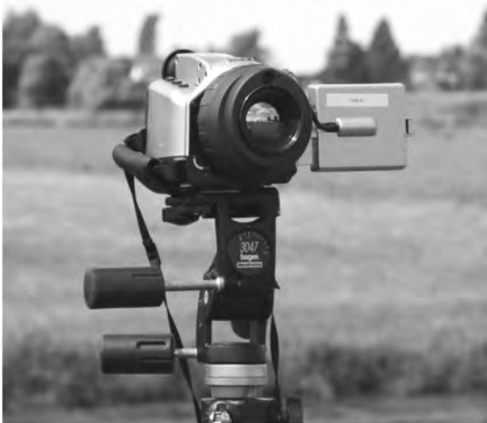
Figuur 5. Thermo Tracer TH9100pro TIR camera voor opnemen temperatuur images.
