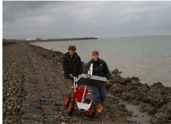
Figuur 1: Links; De microgolven scanner systeem is hier gemonteerd op een utility quad waardoor je op een snelle manier een dijk kunt inmeten. Rechts; De microgolven scanner is hier gemonteerd op een buggy waardoor je op een zeer gedetailleerde manier een dijk kan inmeten. De buggy configuratie is ook het meeste geschikt voor complexe gebieden (denk bijvoorbeeld aan een veenkade met veel hekken).
