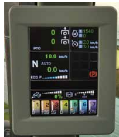
Een nieuw scherm op de A-stijl geeft niet alleen de motor in transmissie-instellingen maar ook de instellingen van de hydrauliek-ventielen.
