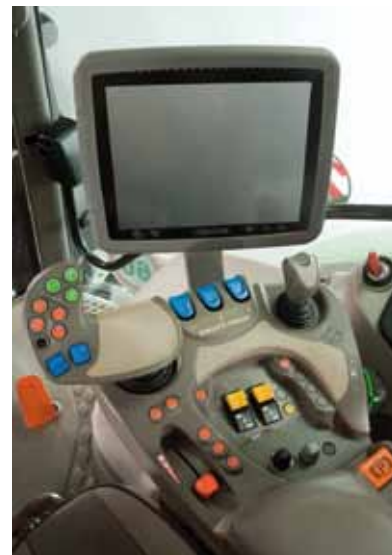
Om het bedieningsgemak te verbeteren is de hele armleuning en joystick opnieuw ontworpen.
