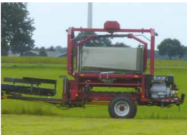
◀ Dankzij de eigen aandrijving is het aan- en afkoppelen een fluitje van een cent. Achter de pers is alleen een trekhaak nodig.
