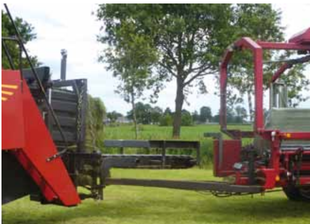
◀ De wikkeltafel blijft altijd recht achter de pers. Als er een baal op ligt, wordt deze hydraulisch recht voor de wikkelaar gebracht.
