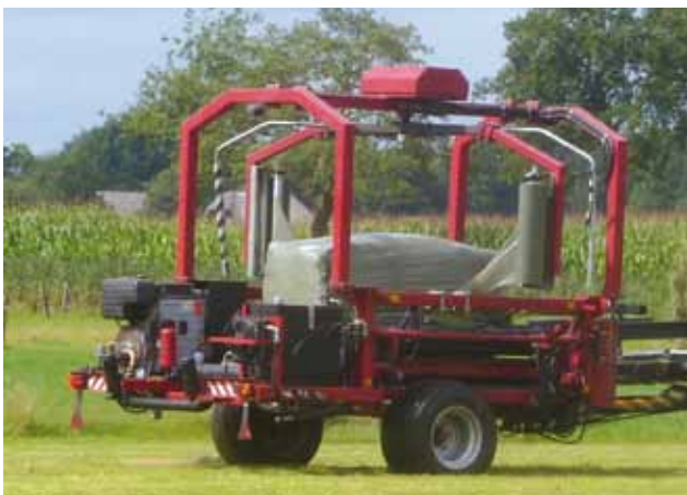
◀ De wikkelaar heeft achterop een eigen powerpack, met een 37 kW (50 pk) motor, en een eigen hydraulisch systeem inclusief oliekoeler.
