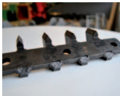
De optionele kloover zorgt dat te grote snippers nog eens gehakseld worden.
