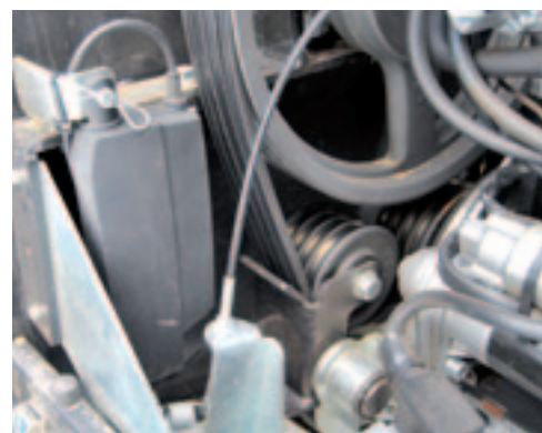
Met een druk op de knop, voer je het motortoeental op waardoor de spanner de snaren spant.
