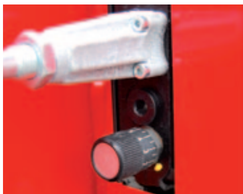
Met een draaiknop varieer je het toerental van de invoerrollen.
