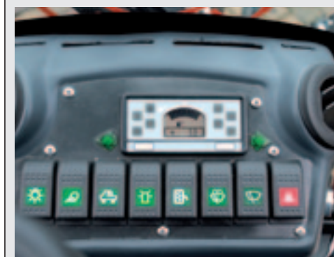
De urenteller en het brandstofniveau zijn op het dashboard eenvoudig af te lezen.
