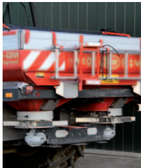
▲ Optionele extra's op de RotaFlow strooier zijn een losse aluminium ladder en een afdekzeil.
