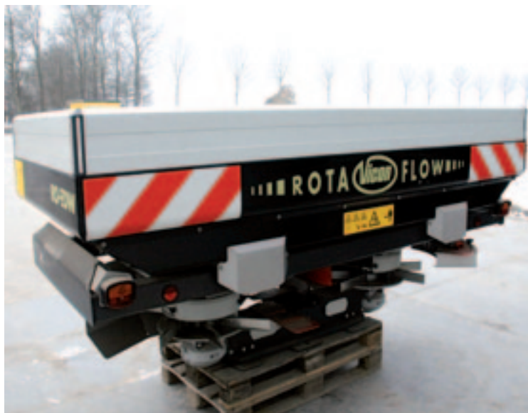
▲ Voor het honderdjarig jubileum werden enkele RotaFlow-strooiers in het zwart gespoten. achter de twee aluminium plaatjes zitten de weegcellen.
