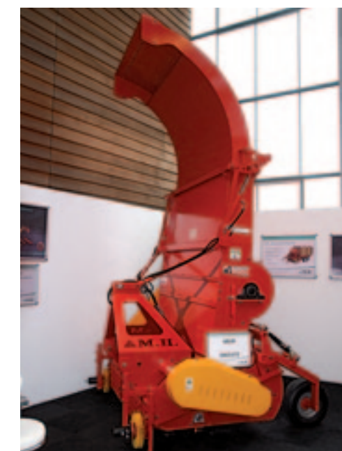
▲ Resten van vaste planten of strokken moeten worden verwijderd. Met een speciaal zuig-apparaat wordt het materiaal opgezogen en vervolgens door de hakselaar omhooggeblazen, net als bij de maailadwagens. In de bollenteelt is een volgwagen taboe. Het af te voeren materiaal wordt verzameld in een bak boven op de trekker. Vooral bij nat materiaal veroorzaakt die extra hoogte nogal eens problemen. Om dat materiaal toch voldoende snelheid te geven, heeft Mechanisatie Haarlemmermeer boven de hakselaar een versneller in de afvoerpijp aangebracht. De stuwkracht is daardoor met 60 tot 70 procent toegenomen.
