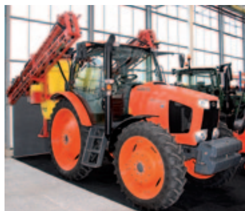
▲ J. van der Sluis introduceerde de Gecko-aanbouwpomp van de Belgische fabrikant Beyne op een Kubota 110 CX. Speciaal voor het spuiten in hoogopgaande bolgewassen was extra veel vrije ruimte onder de trekker gecreëerd door montage van 11.2R36- en 300/95R52-banden. De Gecko-aanbouwpompen worden geleverd in uitvoeringen met tanks tot 1.800 liter en een boombreedte tot 30 m. In de bollensector is veel vraag naar deze betrekkelijk lichte veldspuiten.
