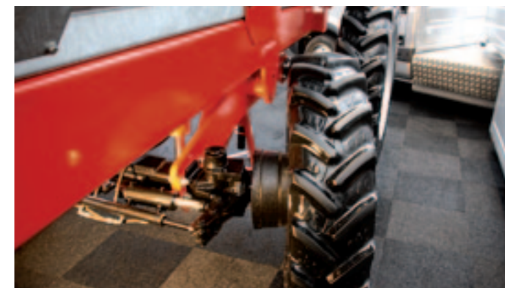
▲ De 13 meter brede paperspuitwagen van Mechanisatie Haarlemmermeer heeft zeven hydraulisch afsluitbare verdeelpunten. Het gewicht van de spuitwagen met 6.000 liter wordt gedragen door een tandemstel met bestuurd voorste wielen. Door bij het terugsteken naar de slootkant de pendelende tandemas aan de voorzijde met twee cilinders naar beneden te drukken komt het achterste wielstel van de grond en kan met de voorste wielen worden gestuurd zonder te wringen. Deze manoeuvreerbaarheid wordt nog vergroot doordat de wagen is uitgerust met een knikdissel.
