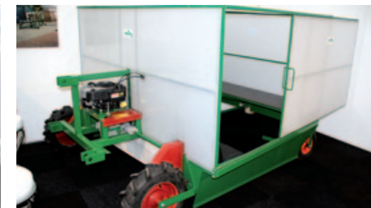
▲ De ziekwagen van Van der Sluis heeft in de tent plek voor twee personen. Voor goede bereikbaarheid kunnen de stoelen scharnieren. De wagen wordt mechanisch aangedreven door een B&S-motor achter de tent. Het bijzondere aan deze ziekwagen is de driepuntsbok rondom de motor. Voor snelle verplaatsingen kun je de wagen in de hef van de trekker hangen. Eenvoudig en effectief.
