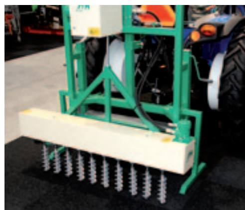
▲ Voor het planten van sierlelies presenteerde Agro Techniek Holland een achtvoudige set grondboren achter een smalspoortrekker. De bestuurder van de trekker kan de afstand tussen de plantgaten elektronisch instellen. Het boren gebeurt rijdend. Om toch vrij rechte plantgaten te krijgen, wordt met een kruk in de bovenste kast de stand van de boor gecorrigeerd. Met boren kun je dieper komen dan met ponsen. Het planten gebeurt aansluitend met de hand.
