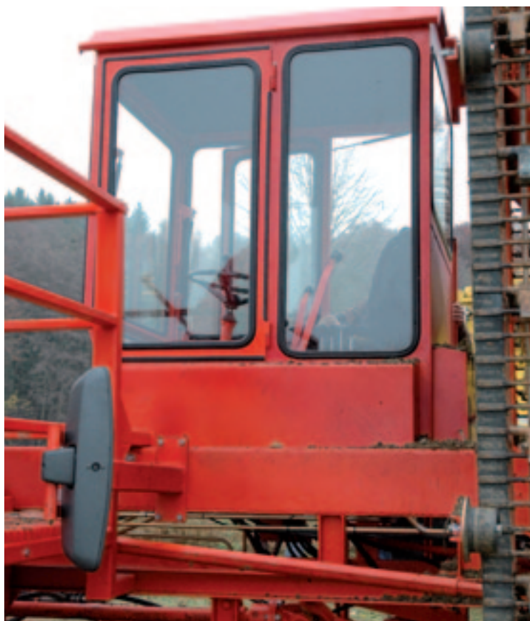
▲ De eerste cabine op een Ropa was net als de trekkercabines uit die tijd vooral hoekig. Van geluidsisolatie was nauwelijks sprake; je zat vooral droog. De huidige cabine komt van een mondiaal opererende fabrikant en doet op het gebied van geluidsdruk en klimaatregeling niet onder voor die van luxe personauto's.
