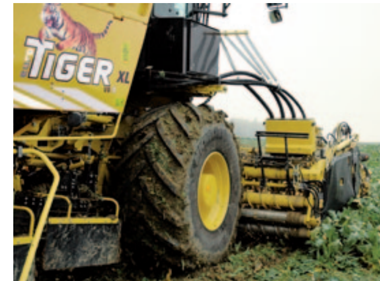
▲ De Euro Tiger XL kan overweg met een 8- of 9-rijig voorzetstuk. Op de vooras van deze rooier passen banden in de maat 900/60R32 of 1050/50R32.
