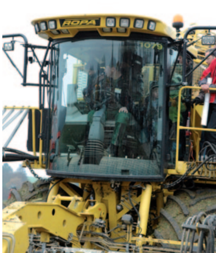
▲ De eerste cabine op een Ropa was net als de trekkercabines uit die tijd vooral hoekig. Van geluidsisolatie was nauwelijks sprake; je zat vooral droog. De huidige cabine komt van een mondiaal opererende fabrikant en doet op het gebied van geluidsdruk en klimaatregeling niet onder voor die van luxe personauto's.
