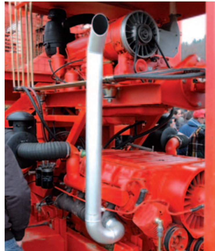
▲ Twee luchtgekoelde Deutz-motoren (links) zorgen op de eerste Ropa voor een gezamenlijk vermogen van 346 pk. Bij de huidige Ropa's zorgt één vloeistofgekoelde zescilinder Mercedes voor een vermogen van 390 kW (530 pk) in de nieuwe tweessige Panther tot aan 440 kW (598 pk) in de grote drieassige Tiger.
