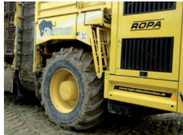
▲ De nieuwe Panther heeft op de achteras rubber in de maat 900/60R38. Op de vooras ligt 800/70R38. De minimum spanning is twee bar.
