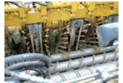
▲ Techniek van 40 jaar oud (boven) met niet-aangedreven rooischaren. Bij de huidige rooitechniek vallen vooral de reinigungsrollen op.
