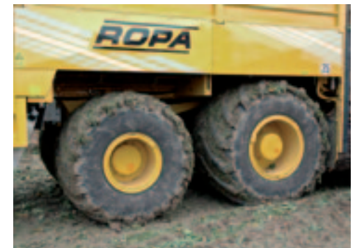
▲ Breed rubber (boven) van 40 jaar geleden was vooral nog klein in diameter. Tegenwoordig gaan breed groot goed samen.
