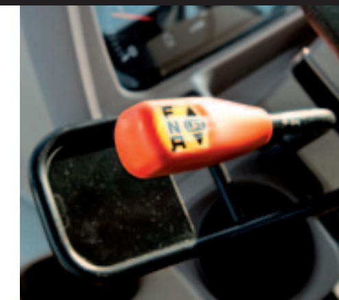
▲ De hydraulische omkeer is een genot. De mate van aangrijpen is weliswaar niet in te stellen, maar dat is ook nergens voor nodig.
