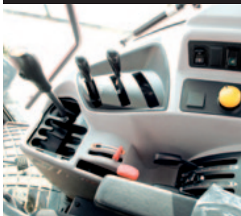
▲ De versnellingsbak van de Kubota 9960 met cabine heeft 6 versnellingen met een hi-lo en drie groepen. Dat levert 36 versnellingen op.
