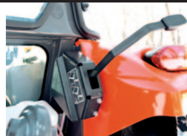
▲ De mechanische hef laat zich van buiten moeilijk bedienen. Het blijkt lastig om de pin in de tanden van de tandheugel te laten vallen.
