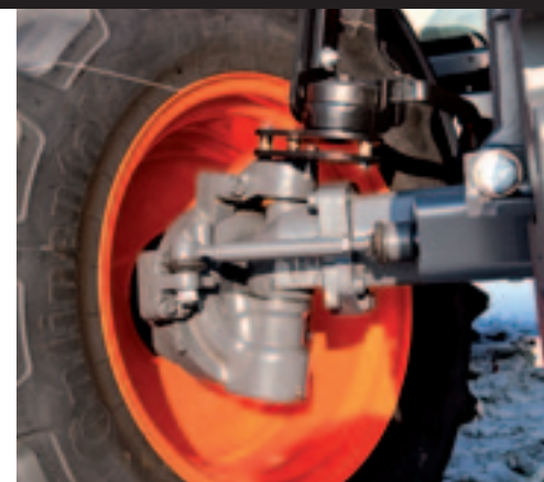
▲ De vooras van de trekking geeft de trekking een hoge bodemvrijheid terwijl de voorwielen ver uitslaan.
