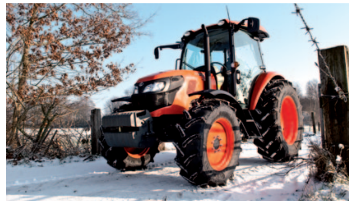
▲ De Kubota M9960 is het grootste model uit de M60-serie. De trekking volgt de 9540 op. Grootste verschil met dat model is de nieuwe motor die aan de Stage 3b-milieu-eisen voldoet.
