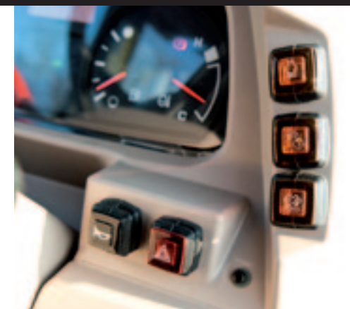
▲ Het roetfilter moet je regelmatig schoonbranden. Dat kan automatisch in het veld of met de hand middels een druk op de knop.
