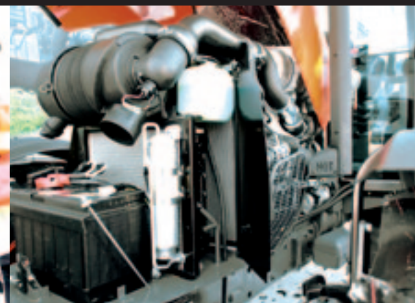
▲ De Kubota M9960 is voorzien van een nieuwe viercilindermotor met EGR en een filter dat roet uit de uitlaatgassen haalt.
