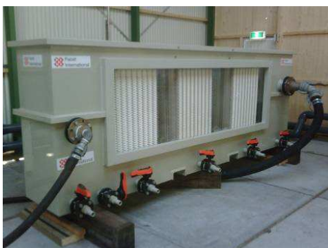
Figuur 3.4: overzicht van de pilotinstallatie lamellenbezinker (links) en lamellen geïntegreerd in een TAST2 bergbezinkbassin van FACET (rechts).
