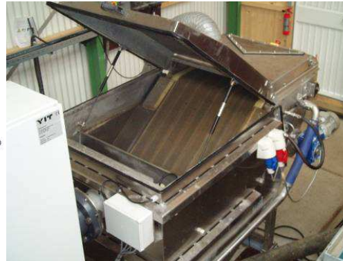
Figuur 3.6: schematische weergave van Fijnzeef (links) en Fijnzeef pilotinstallatie met voorgeschakelde mengtanks (rechts)
