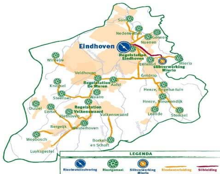
Figuur 2.1: schematisch overzicht aanvoerstelsel riolering cluster Eindhoven
