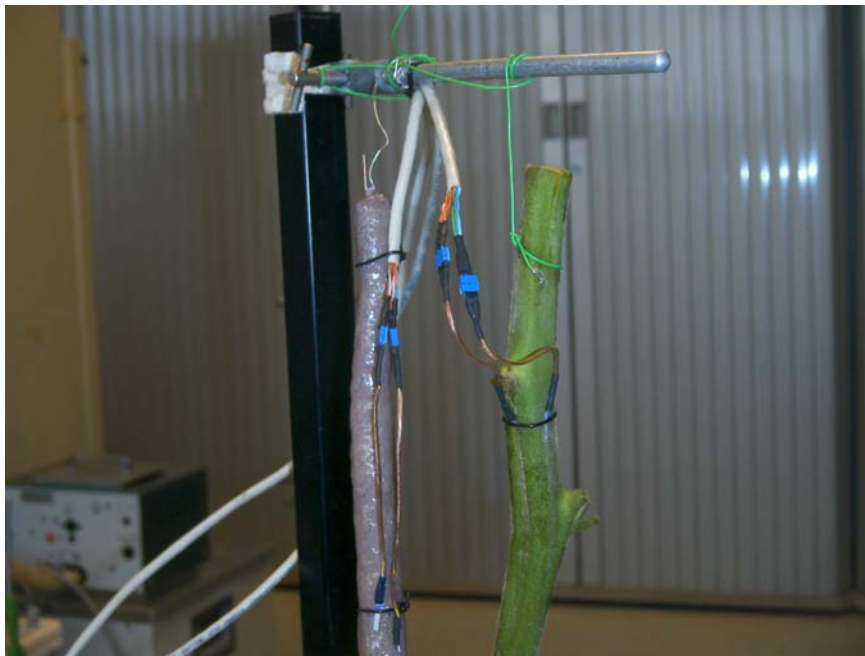
Figuur 10 Meting echte stengel en artificiële stengel in laboratorium.
