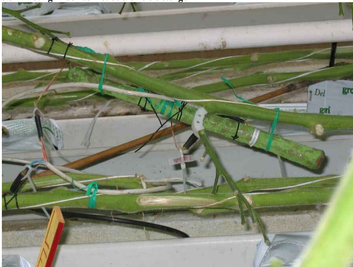
Figuur 19 Foto van de artificiële stengel naast een echte stengel met de sensoren
