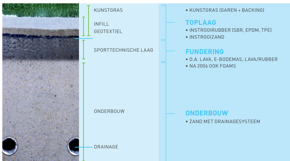
Figuur 2.1 Schematische opbouw kunstgrasveld
