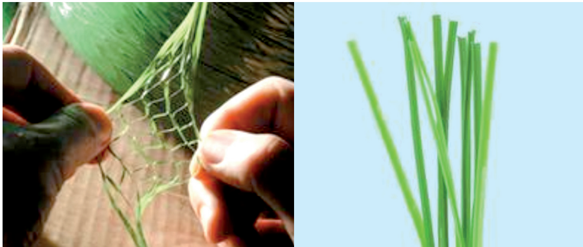
Figuur 2.2 Typen kunstgras (links gefibrilleerde vezels, rechts monofilament)
