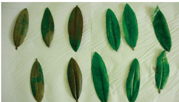
Foto 1. Links Rhododendron blaadjes aangetast door Phytophthora; afkomstig uit water vóór het langzame zandfilter. Rechts blaadjes vrij van Phytophthora, deze hingen in het water nadat het door het langzame zandfilter ging.
