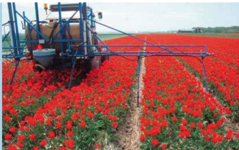
Een padenspuit bestrijdt het onkruid waar het het meest groeit: in de paden en langs de padranden. Het gebruik van deze spuit voorkomt gewasschade en heeft minder middelgebruik tot gevolg.
