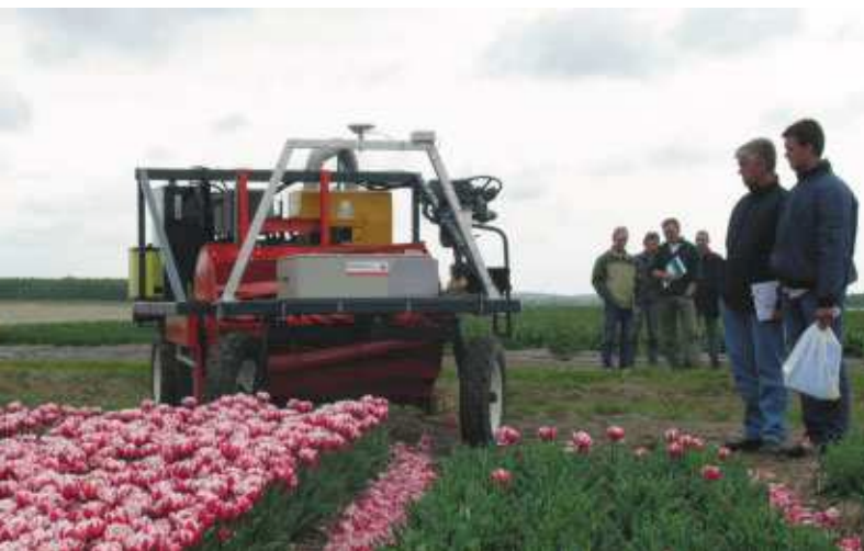
Het AutoMaatje voert zelfstandig werkzaamheden uit, zoals het kappen van tulpen.
