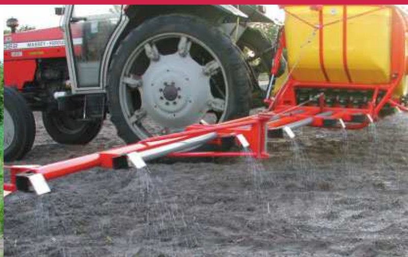
Met een beddenbemester komt alleen kunstmest op het teeltbed en niet op de tussenliggende paden.
