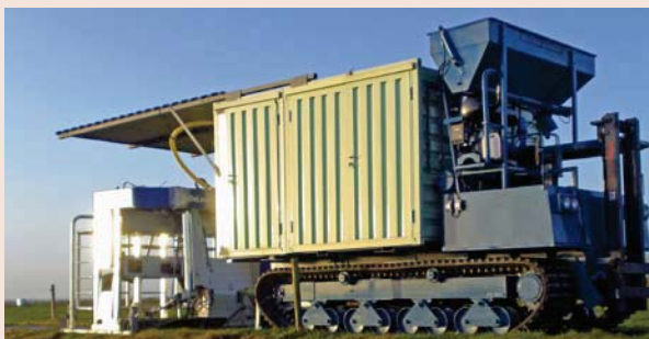
Het idee achter het ontwerp van de Naturelur is simpel: niet de koe naar de robot maar de robot naar de koe.
