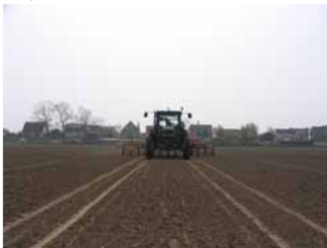
Afbeelding 3.4 Vaste rijbanen met RTK-GPS
