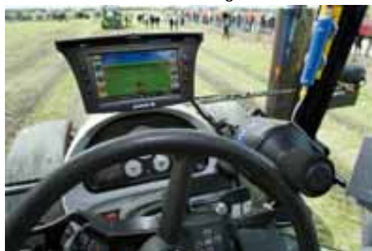
Afbeelding 3.2 Automatisch sturen met opbouw systeem
