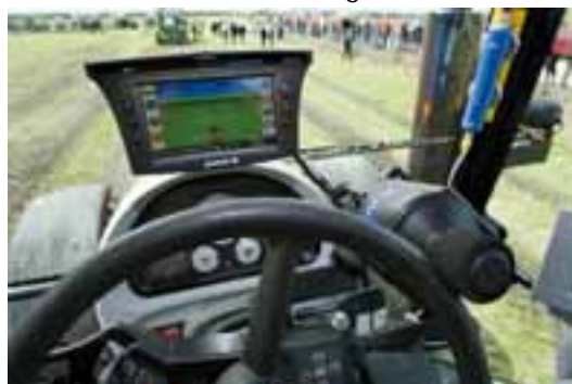
Afbeelding 3.2 Automatisch sturen met opbouw systeem
