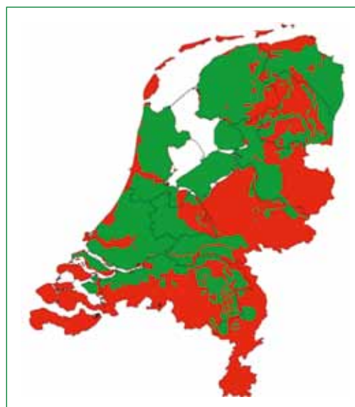
Figuur 3.8 Aanvoermogelijkheden van zoet water vanuit het huidige hoofdwatersysteem in Nederland. Gebied waar naar toe water kan worden aangevoerd vanuit het hoofdwatersysteem aangegeven in groen (Bron: website Klimaat effect atlas)
