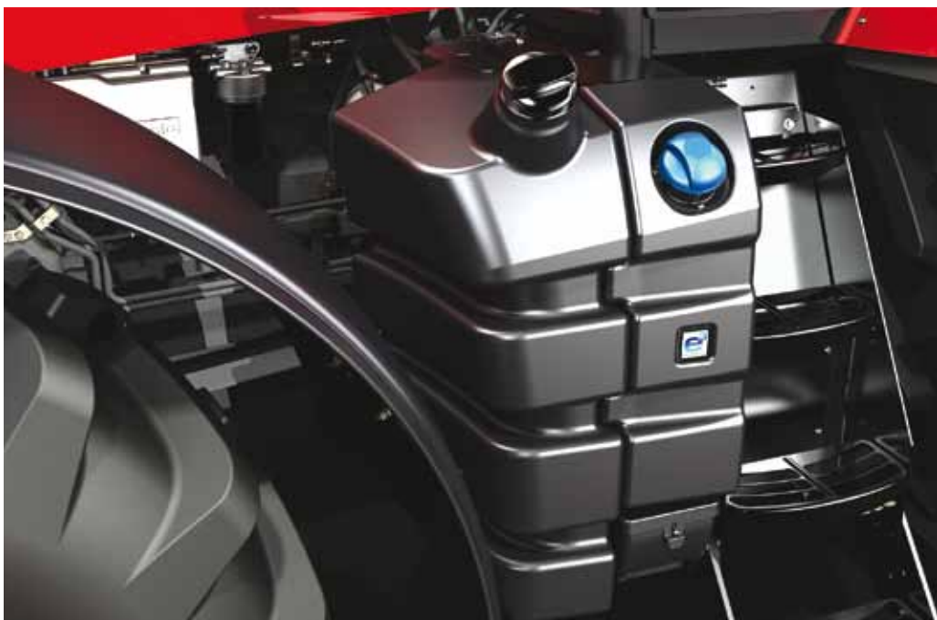
Een aparte tank voor AdBlue, een ureumproduct dat stikstofoxide reduceert tot water, stikstofgas en CO 2 .
