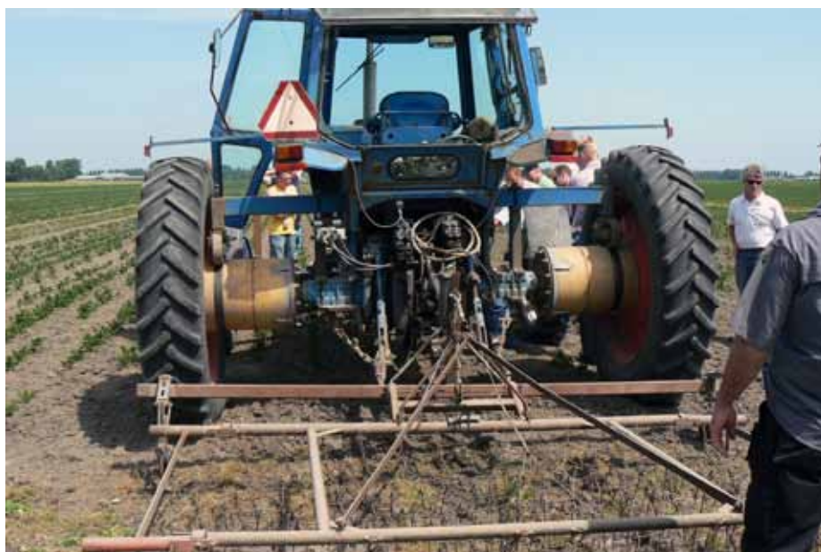
Een goedkope manier om tractor op 3,10 m spoorbreedte te zetten.
