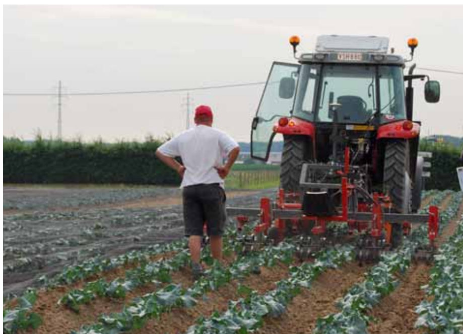
RTK-GPS neemt tijdens het schoffelen het stuur van de tractor over. Hierdoor kan de chauffeur zijn volle aandacht richten op een goede afstelling en een goede werking van de schoffelmachine.
