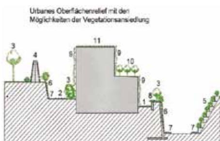
1 = Schotterrasen, 2 = Hasensteine, 3 = unzureichend, bodenoberflächennetz und Kriechkletterpflanzen, 4 = begrenzte Lärmschutzwände, 5 = begrenzte Stützende aus Betonmörtel, 6 = Begrünung von Stahlblechfassaden mit Mikrofasern, 7 = Fassaden- und Saunfassaden, 8 = Begrünung von Mauerwerk, 9 = Fassadenbegrünungen, 10 = intensive Dachbegrünungen, 11 = extensive Dachbegrünungen
