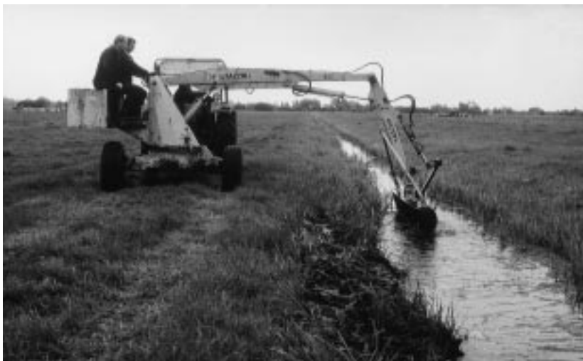
Figuur 2. Met een slootbak kunnen zowel water- en oeverplanten als bagger worden verwijderd (Twisk e.a. 2000).
