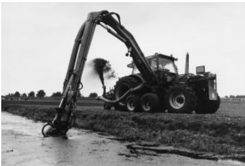
Figuur 3. Met de baggerspuit (baggerpomp, baggerzuiger) wordt modder uit de sloot gezogen en over het aangrenzende land verspreid (Twisk e.a. 2000).
