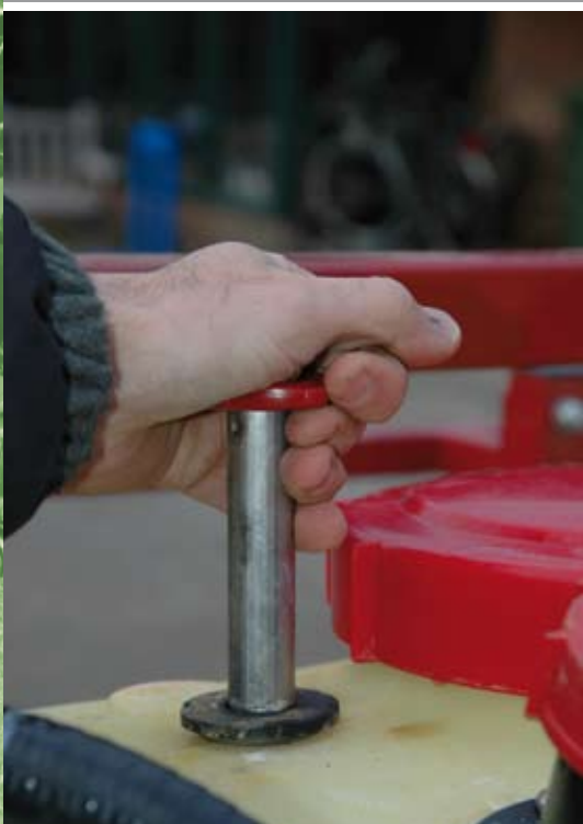
De tank gemakkelijk helemaal leeg laten lopen: nooit er meer onder kruipen.
