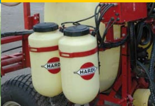
De twee communicerende vaten voor de vloeistof van de schuimmarkeurs en de slangenhaspel voor het spuitpistool.
