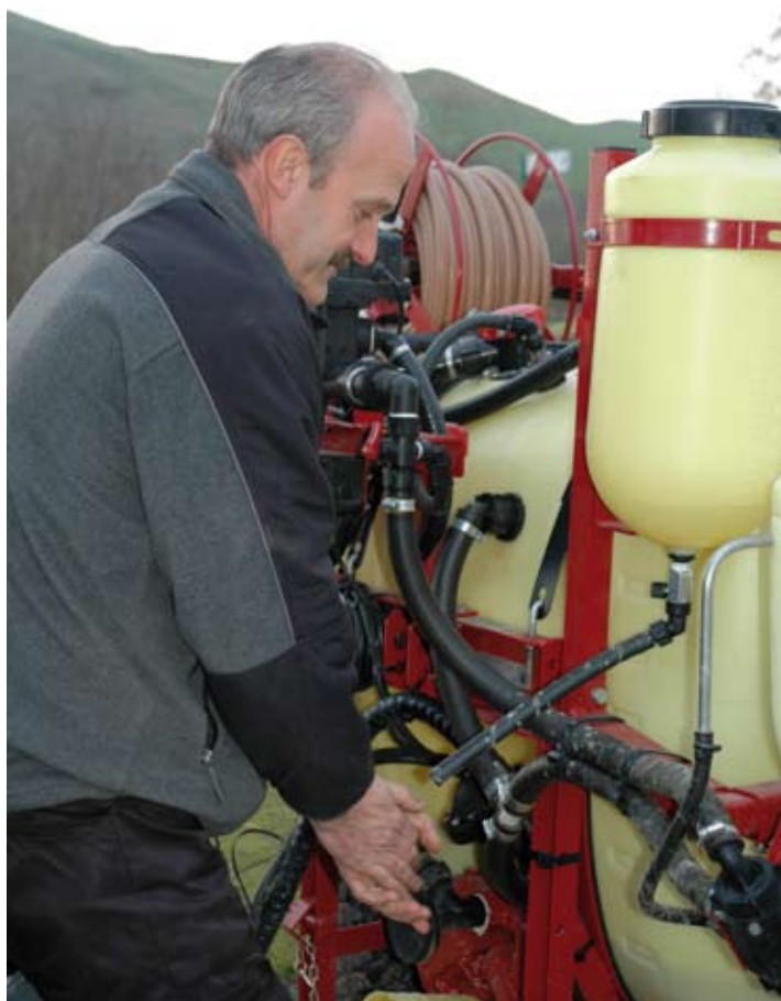
Schoon water om je handen te wassen.
