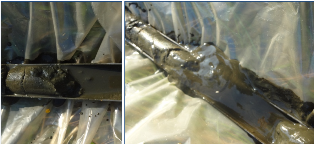
figuur: monsters waterbodern in slibvang. Duidelijk zichtbaar de sliblaag bovenop de vaste zandbodem
