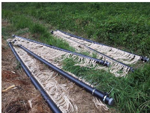
Figuren: plaatsing perifytonfilter
