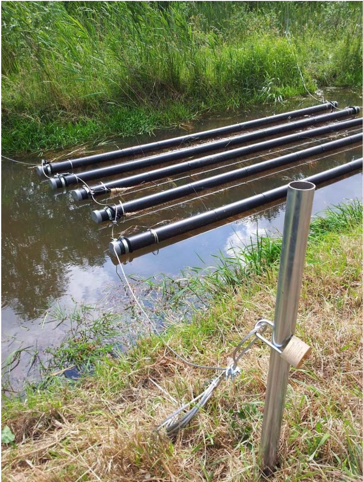
Figuur 2. Verankering systeem, met speling in kabel voor eventuele peilverhogingen. De gele tape is later geplaatst.
