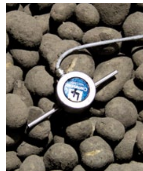
▲ Maximaal vijftien temperatuurvoelers voor het product zijn per cel te monitoren.
