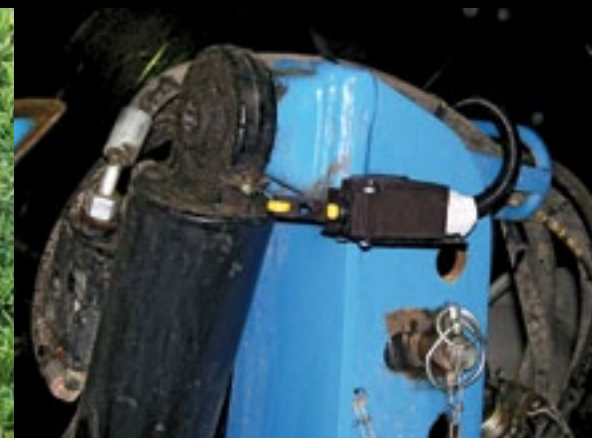
▲ Een sensor die waarneemt aan welke zijde geploegd wordt, is standaard bij Meijworks. Deze is van Agrometius en optioneel.
