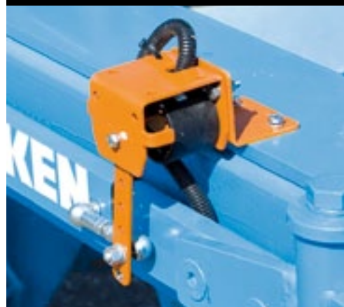
▲ De potmeter van SBG ziet er anders uit dan die van Agrometius. Het idee is echter hetzelfde: de hoogte van de spanning vertelt de hoek.
