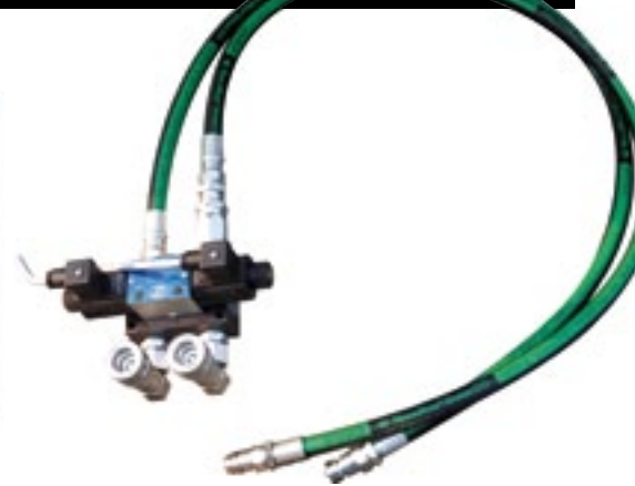
▲ Meijworks gebruikt snelkoppelingen in het hydraulische systeem. Mocht het onverhoopt niet werken, dan kun je handmatig verstellen.
