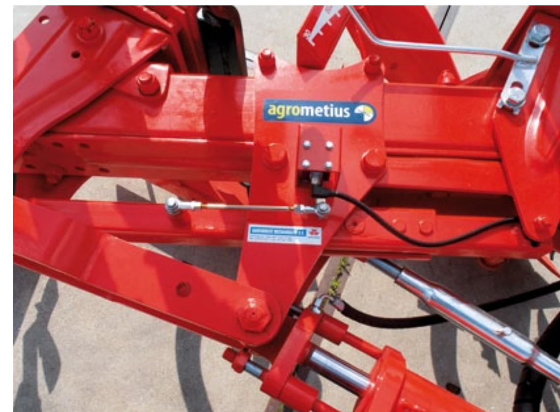
▲ Leveranciers gebruiken een potmeter om de hoek van de ploeglichamen ten opzichte van de balk te bepalen. Zo wordt de ploegbreedte bepaald. Elke ploeg moet gekalibreerd worden.
