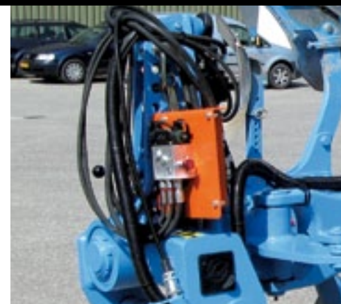
▲ Om de variocilinder te kunnen sturen, is een elektrohydraulisch ventiel nodig. Als dat er niet is, moet het worden opgebouwd.
