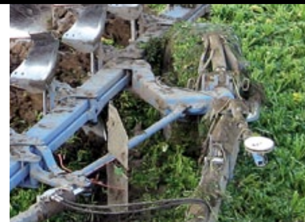
▲ Om on-land te ploegen werkt SBG met een tweede antenne. Volgens SBG is het zonder onmogelijk om on-land te ploegen
