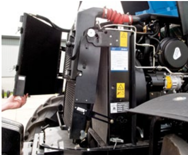
▲ Het koelpakket is voor onderhoud goed toegankelijk doordat het in delen uit- en wegklapbaar is. Met perslucht kun je er dan makkelijk bij. De 6,7 liter zescilinder legt in het veld een weerstand aan de dag om u tegen te zeggen.
