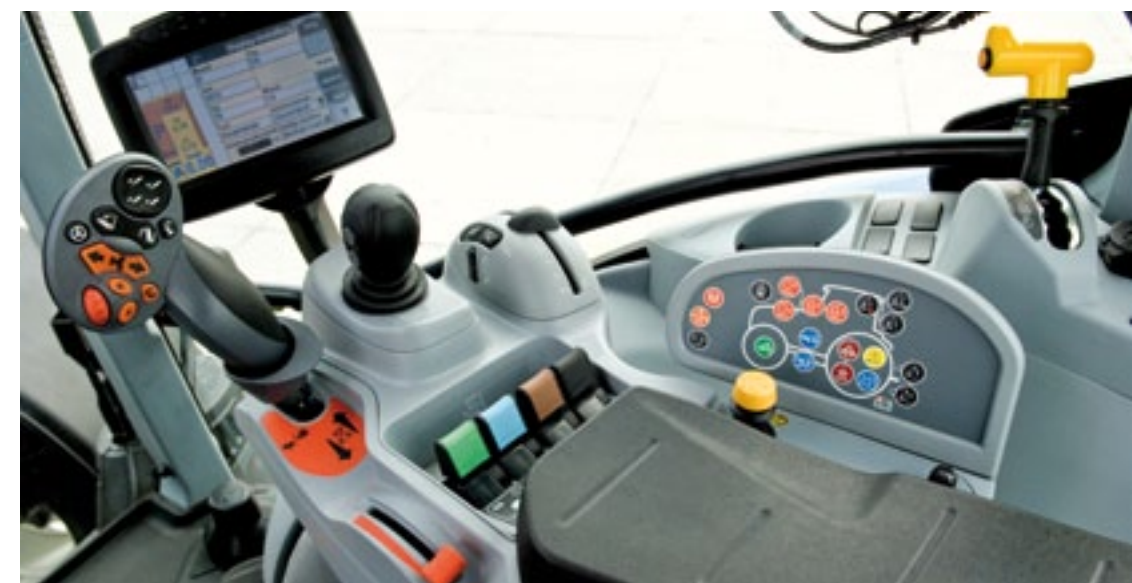
▲ Sidewinder-armleuning met de rijhendel (links) en de kleurrijke flippers en joystick voor de hydrauliek.
