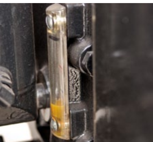
▲ Peilglas voor het olieniveau in de achterbrug.
