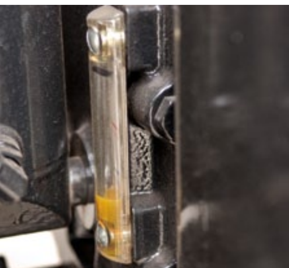
▲ Peilglas voor het olieniveau in de achterbrug.
