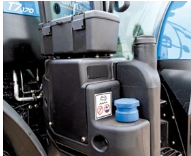
▲ De dieseltank heeft een inhoud van 270 liter; voldoende voor lange dagen. In de AdBlue-tank (op de voorgrond) past 51 liter. Op de gereedschapskist valt het nodige aan te merken, maar het is desondanks plezierig dat hij er is.
