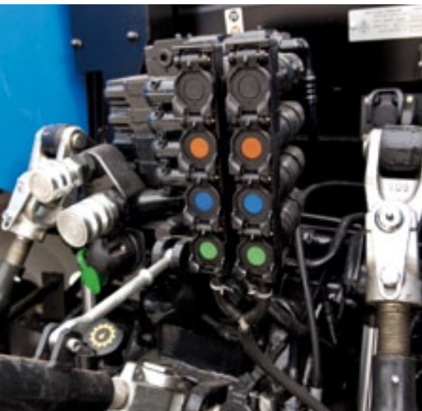
▲ 4x DW met doorstroomregeling in de cabine.
