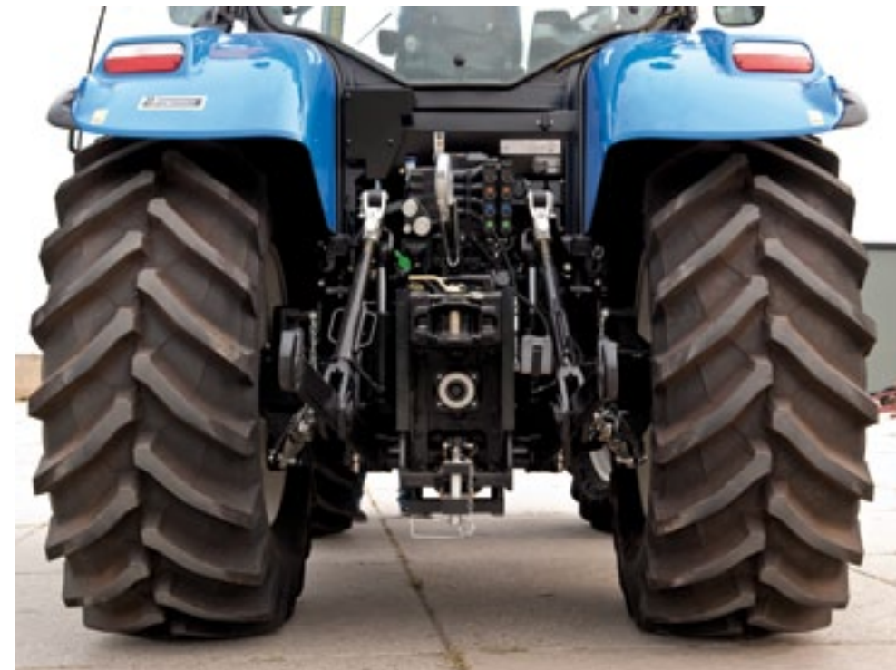
▲ De hef van de T7.170 levert veel kracht en heeft ruime verstelmogelijkheden. De vier dubbelwerkende hydrauliekventielen worden elektrisch aangestuurd. De standaardachterband is de TM800 van Trelleborg met de maat 650/65R38. Bij de aftakas is er keuze uit drie toerentallen; de optie van vier is er niet.
