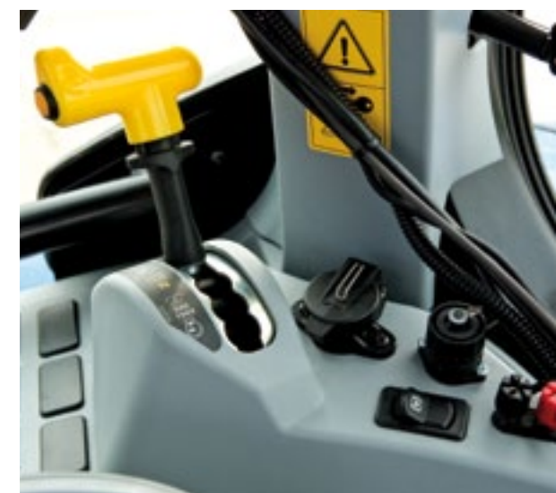
▲ De toerenschakeling van de pto is onduidelijk.
