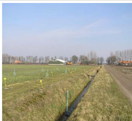
Peilbuizen en piezometers in bufferstrook en perceel op PPO-proefbedrijf Vredepeel (O.A. Clevering)
