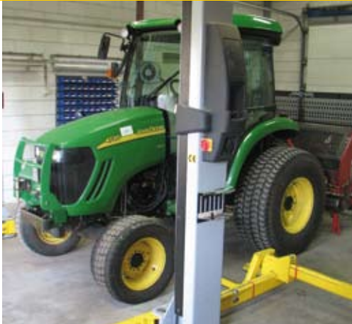
Tweekolomshefbrug, in lengte en breedte verstelbaar.
