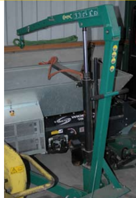
Loopkat voor transport van zware zaken van hefbrug naar werkbank.
