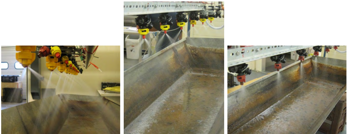
Figuur 1. Spuitbeeld van de drie driftreducerende spuitdoppen; venturi spleetdop (links), tweewaaier spleetdop (midden) en hispeed tweewaaier spleetdop (rechts).
