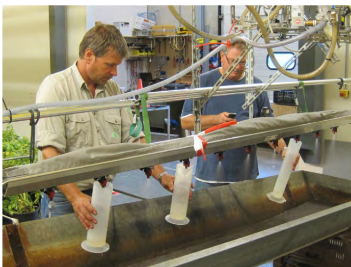
Figuur 2. Meten van de dopafgifte per dop aan de spuitboom.
