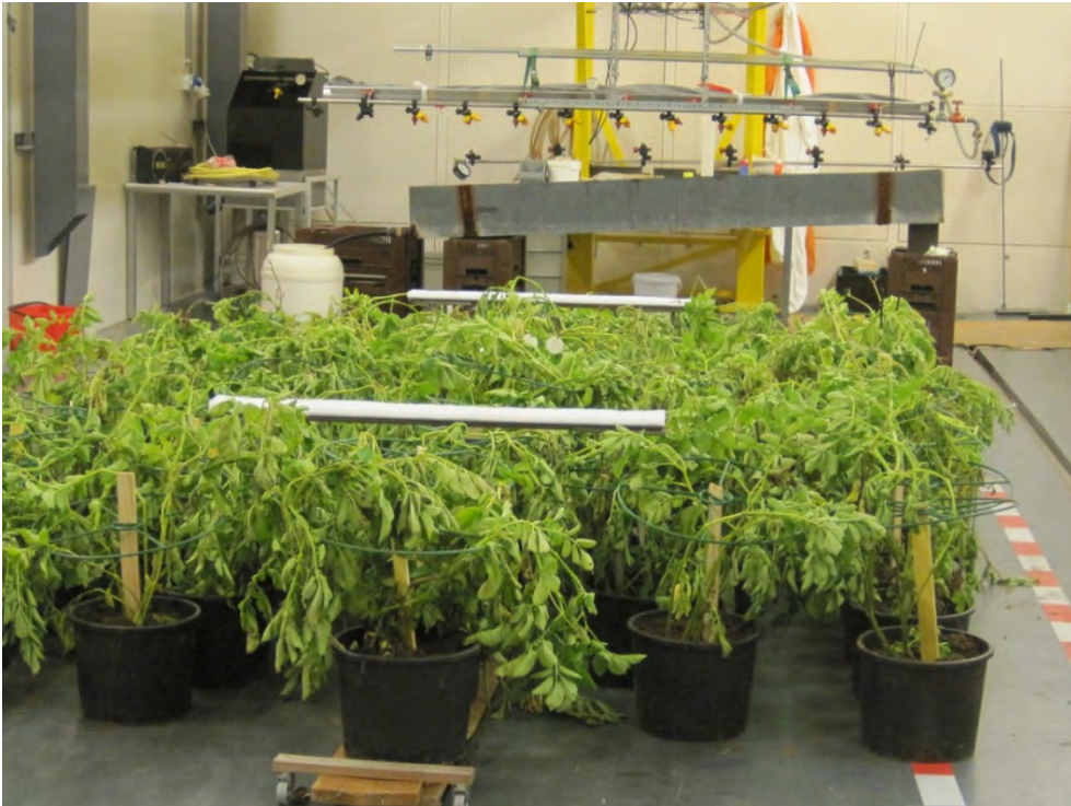
Figuur 4. Overzicht aardappelgewas in spuitbaan met filter collectoren dwars boven het gewas en spuitboom aan traverse systeem.
