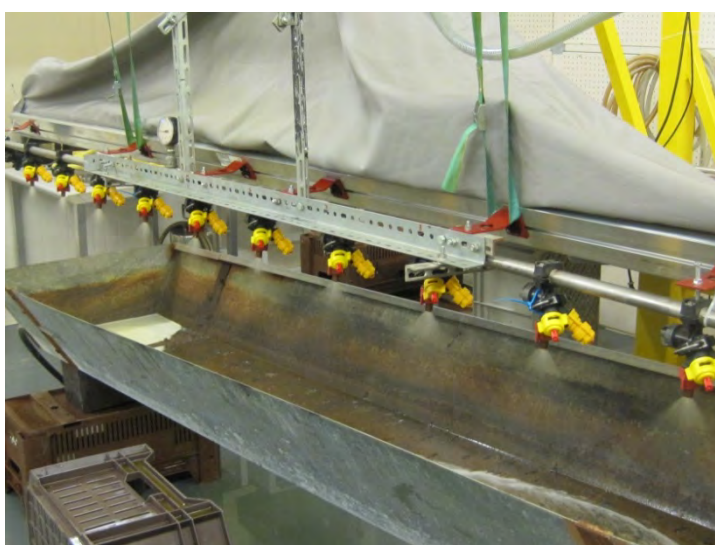
Figuur 3. Luchtondersteuning door luchtzak (systeem Hardi Twin) aan spuitboom en ventilator bevestigd aan traverse systeem in spuitbaan.
