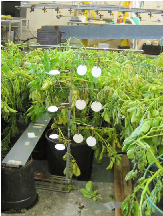
Figuur 5. Wisselplant en rondfilter collector opstelling en filtercollector positie op pot en op grond positie tussen aardappelplanten.
