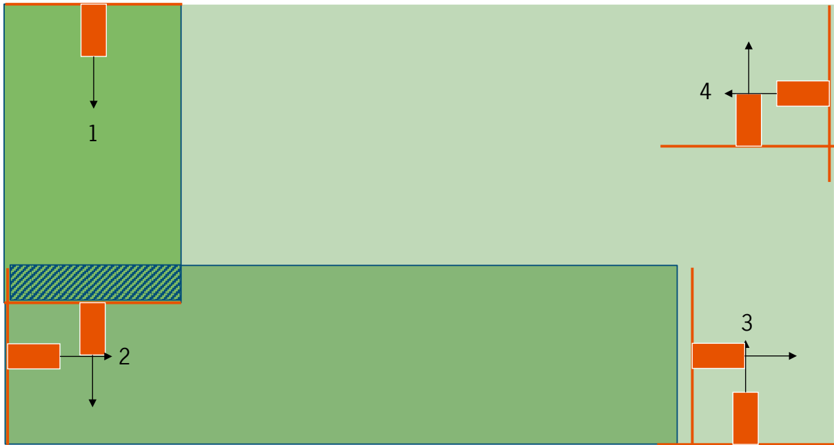
Figuur 1. Volgorde van werkslagen (1, 2, 3, 4) op de kopakker op een rechthoekig perceel en overlap van de bespuiting in de hoeken (gearceerd bij werkslagen 1 en 2).
