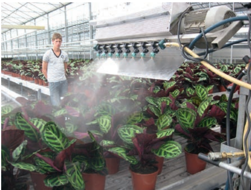
Figuur 10. Luchtgordijn achter (aangepaste) spuitboom, rijrichting planten van links naar rechts.
