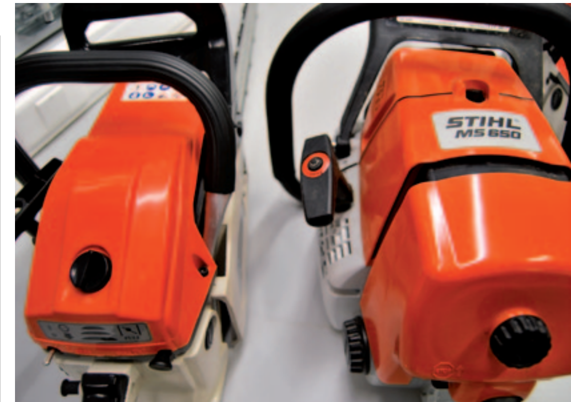
■ Een nagemaakte (I) en een echte Stihl MS 650 naast elkaar. De laatste heeft een grotere behuizing.
